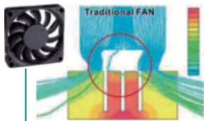
圖一 傳統散熱風扇熱流分析
